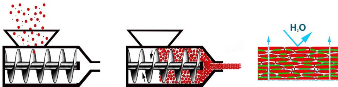
Proceso y estructura materiales extrudidos Gres Aragón. Process and structure of Gres Aragón extruded materials.
